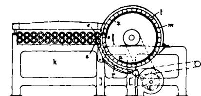
einsaugende Saugwalze (s) eingebaut ist, deren Mantel von der Zuführungsstelle (e) der Fasern an auf eine Strecke ( $o$ ,  $o_1$ ) unterbrochen ist und die an einen Exhaustor angeschlossen oder in die ein Saugventilator eingebaut ist. — 2. dad. gek., daß die Schlagwerkzeuge (m) behufs Beeinflussung der Saugwirkung einstellbar sind. — (D. R. P. 411 653, Kl. 29 a, vom 29. 3. 1923, ausg. 6. 4. 1925.) dn.
